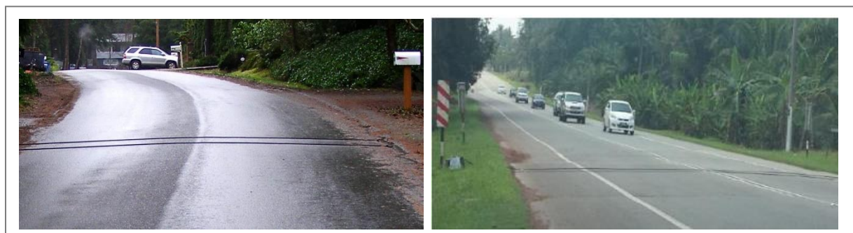
Рисунок 3. Подсчет автомобилей по пневматическим дорожным трубам
