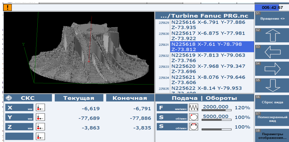
Рисунок 11. Работа УП в процессе 5D обработки по поверхностям. На рисунке 12 представлен результат черновой обработки детали.
