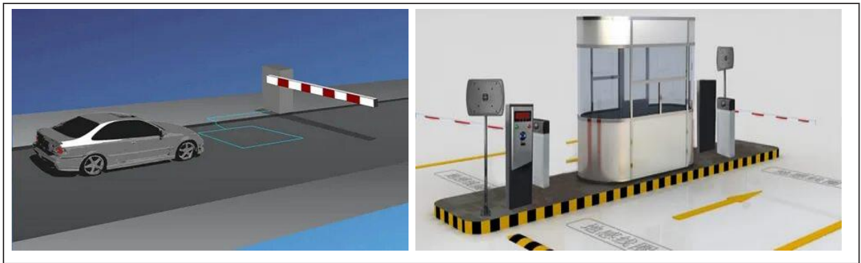
Рисунок 5. Подсчет автомобилей с помощью магнитных колец
